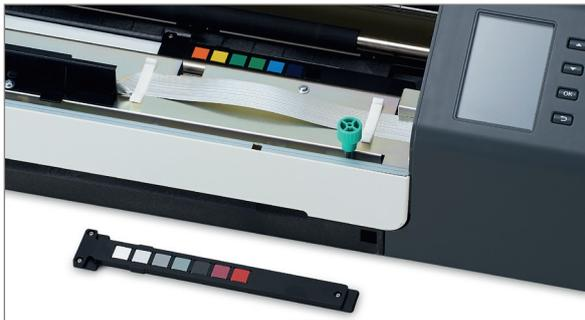
Die Selbstdiagnose des FD-9 ermöglicht Anwendern zu jeder Zeit die regelmäßige Überprüfung des Systems zu jeder Zeit. Die Selbstdiagnose wird mittels speziell für das FD-9 entwickelten zertifizierten BCRA-Kacheln vorgenommen.
